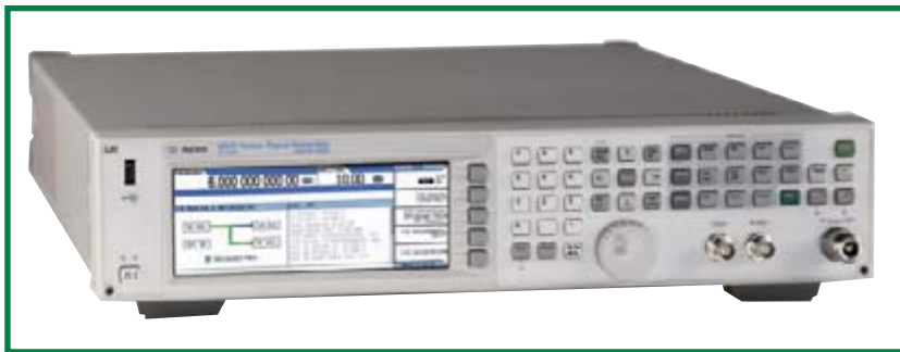
Figuur 1. Foto van een professionele generator van Agilent, type N5182MXG, met een frequentiebereik tot 6 GHz.
