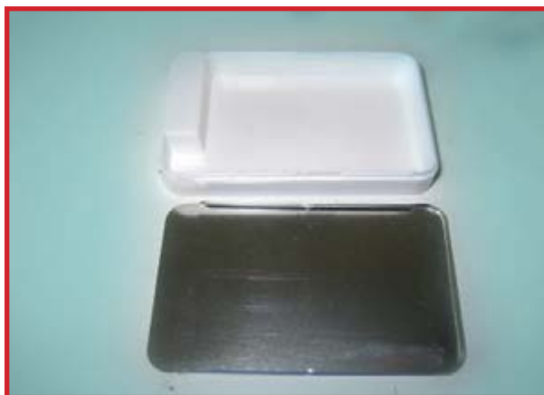
Als behuizing is gekozen voor een leeg Wybertjes-doosje. Net groot genoeg om 3 AAA-batterijen, het printje en de connector in te verwerken.
