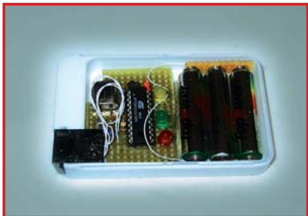
Het past precies. Het zwarte blokje links is de UTP-connector.
