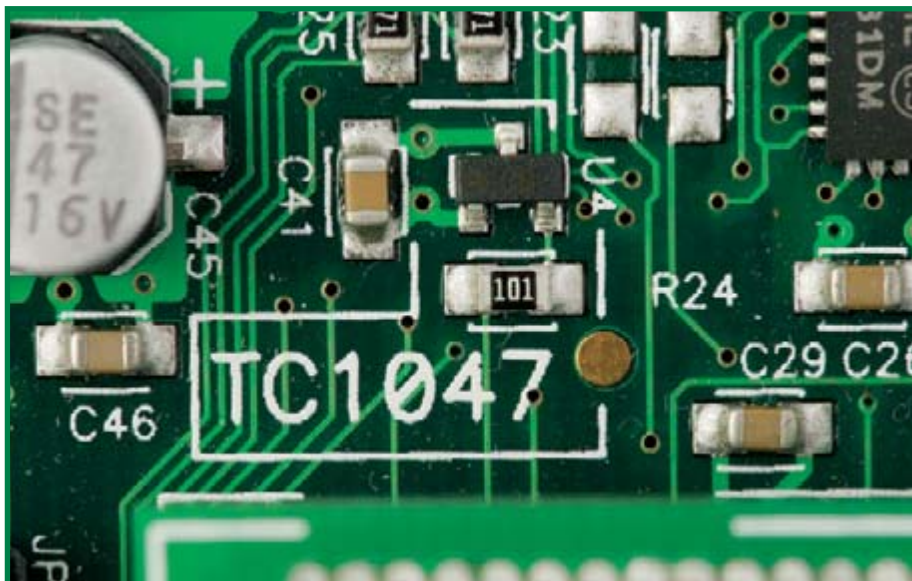
Figuur 2. De TC1047 temperatuur sensor op het Explorer-16 demo-board. Deze wordt volledig ondersteund door de systeem-software en is gemakkelijk vanuit C te benaderen.
