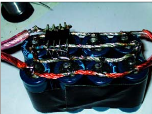
De MOSFET's. We hadden geen zin in opgeblazen printplaten, dus hebben we het prototype bovenop de condensatoren 'in de lucht' opgebouwd.
