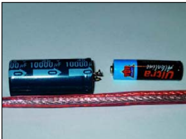
Het hoofdonderdeel: de condensator. Dit is een 10.000 \mu\text{F} -versie. Hiervan knopen we er 8 met dikke luidsprekerdraad aan elkaar (de batterij is een penlite, ter referentie)
