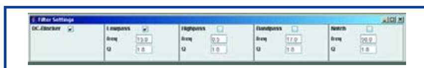
Figuur 8. In het venster 'Filter Settings' zijn de software-matig uitgevoerde biquad infinit e-impulse-response filters te configureren.
