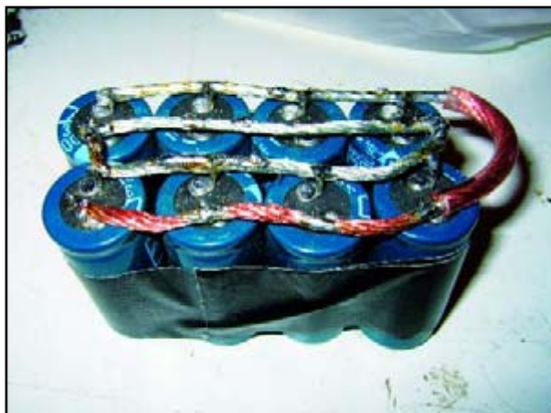
Zo dus. De luidsprekerkabel is gestript en goed vertind op de plaatsen waar de condensatoren eraan gesoldeerd zijn.
