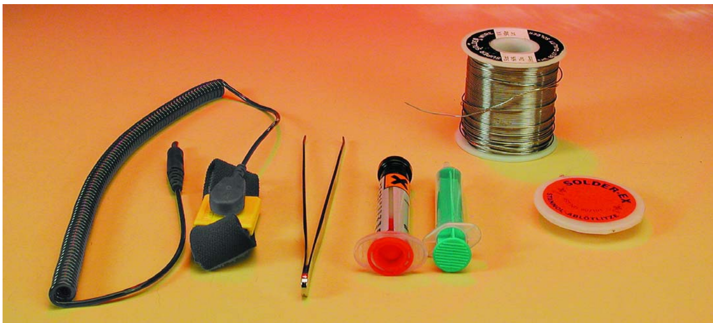
Figuur 6. Uitrusting voor de verwerking van SMD-onderdelen (van links naar rechts: aardingsband, pincet, vloeimiddel, soldeer en tinzuiglitze).
