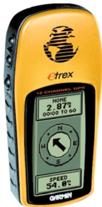
Figuur 6. Ook goedkope GPS-handontvangers hebben vaak een NMEA-aansluiting.
