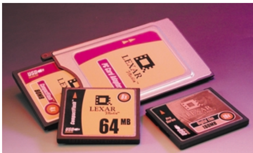
Figuur 7. Een PCMCIA-adapter van Lexar voor CF- en CF+-modules.
