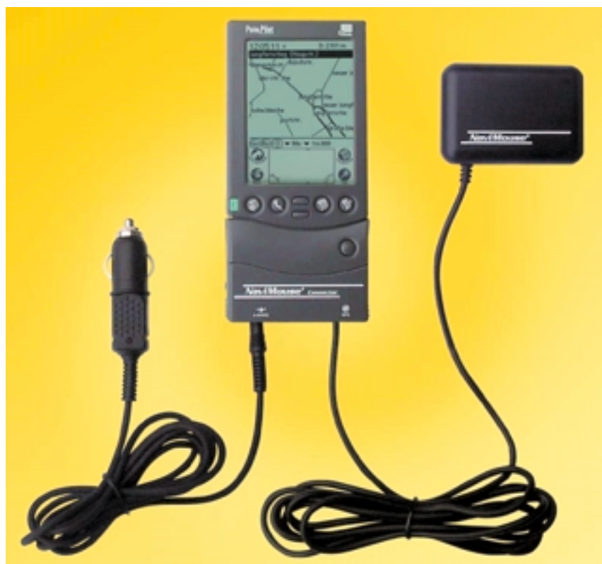
Figuur 5. Een GPS-muis bevat een compacte GPS-ontvanger met geïntegreerde antenne en kan rechtstreeks aan de seriële poort of de USB-poort worden aangesloten. Hier een NaviMouse voor aansluiting aan een Palm-PDA.
