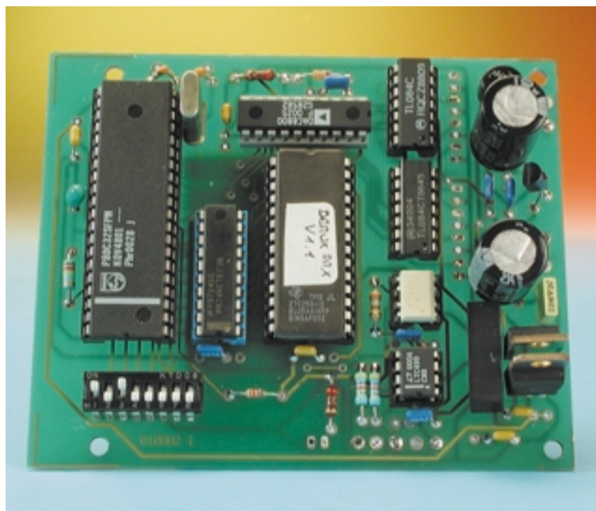
Figuur 3. Opgebouwd prototype van de DMX-demultiplexer.
