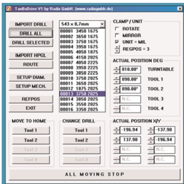
Figuur 4. In TanBoDrive wordt een Excellon-bestand geïmporteerd en de print gejusteerd.
