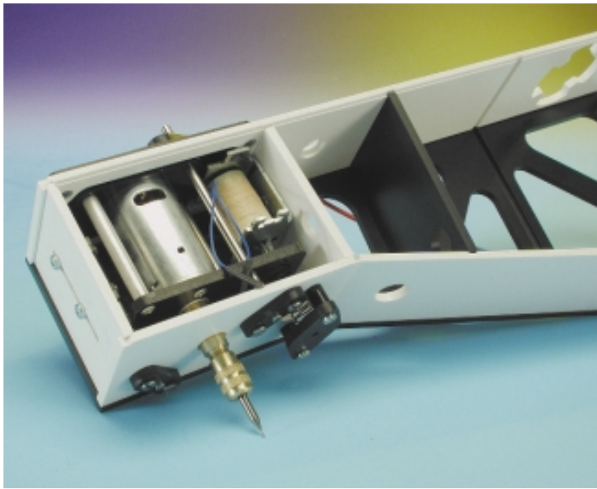
Figuur 3. Gedeeltelijk verlijmd werktuigarm met reeds ingebouwde spindel/hefmagneet-unit.
