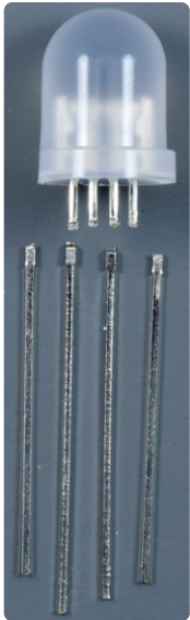
Figuur 7. De aansluitdraden van de RGB-LED's van het type WS2812D-F8 zijn net boven de verbreding afgeknipt.
