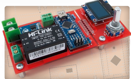
DHZ-reflowplaat voor assemblage of reparatie van kleine SMD-schakelingen
