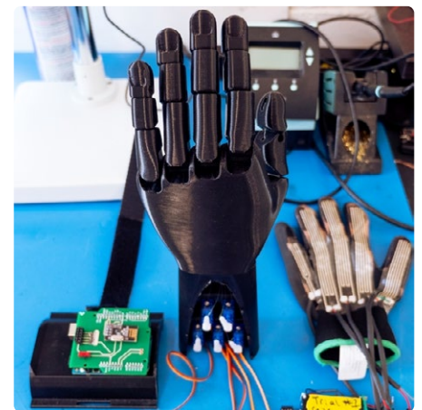
Figuur 6. Door gebruik te maken van de veranderende weerstand van geleidende inkt op een rekbaar substraat kan via rekstrookjes in de vingers van deze handschoen een robohand worden bestuurd.
