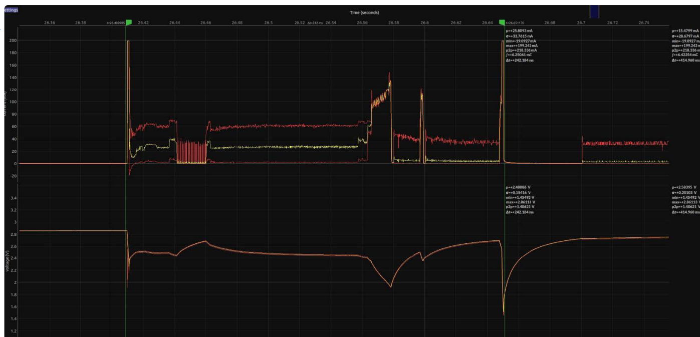
Figuur 5: Oscilloscoop-screenshot van spanning en stroom tijdens de verzending van een standaard datapakket.
