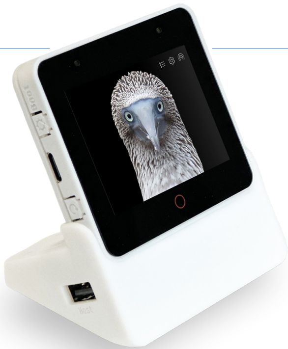
Figuur 3. ESP32-S3-BOX-3 wordt geleverd met een 2,4-inch display, twee microfoons en een luidspreker.
