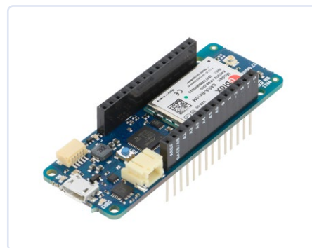
Figuur 7. De Arduino MKR NB 15-module voor communicatie via Narrowband IoT-netwerken.
