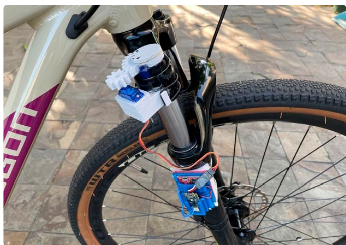
Figuur 3. De slimme fietsvering gemonteerd op de voorwielophanging van een fiets. Bovenaan de servomotor die de stijfheid van de schokdemper aanpast.
