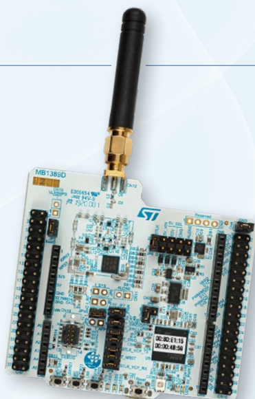
Figuur 3. De NUCLEO-WL55JC is compatibel met standaard- en merkspecifieke protocollen zoals LoRaWAN, Sigfox, wM-Bus en meer.
