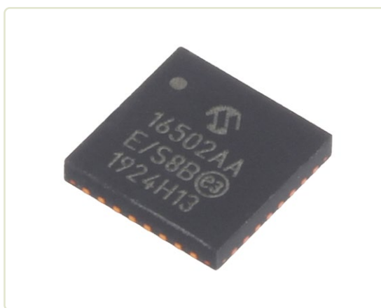
Figuur 1. De VQFN32-behuizing maakt het mogelijk de afmetingen tot 5 \times 5\text{ mm} te beperken.
