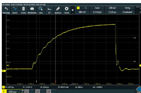
Figuur 6. Referentiemeting met 1 kΩ pull-ups, meerlaags SMD-ferriet, TVS-diode-array, 20 cm verbindingskabel en 400 pF MLCC's (= 344 ns stijgtijd).
