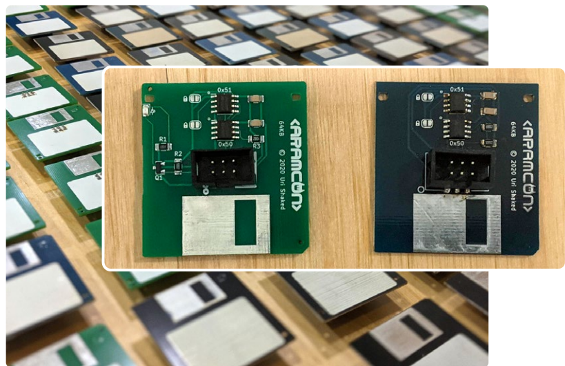
Figuur 10. De Floppy Disks, met een close-up van de elektronica (twee EEPROM's, write-lock soldeerjumpers en een indicatie-LED).
