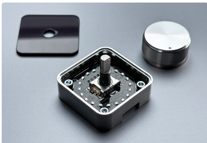
Figuur 23. De encoder is geïnstalleerd.
