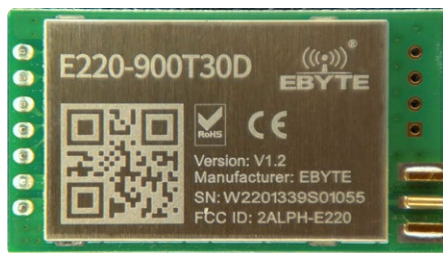
Figuur 2. De E220-900T30D module bevat een 8dB-vermogensversterker, die het zendvermogen verhoogt tot 30 dBm of 1 W.
