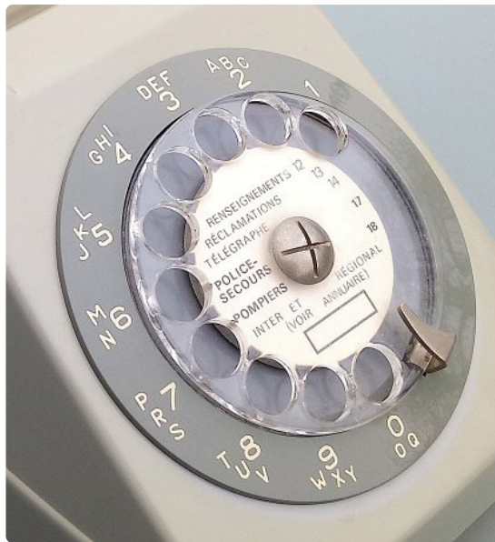
Figuur 8. Sms'en met deze oude telefoon is gemakkelijk dankzij de letters die rond de kiesschijf is afgedrukt. Zo wordt 'elektor' gekozen als 33-555-33-55-8-0-77, waarbij elk streepje staat voor een pauze van één seconde.
