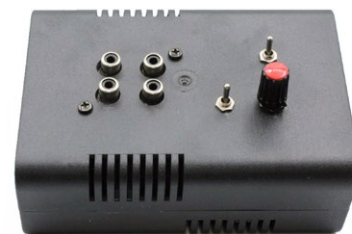
Figuur 4. Het prototype van de auteur: de in- en uitgangen, samen met de twee schakelaars en de potentiometer voor het aanpassen van het vervormingsniveau, bevinden zich aan de bovenkant.
