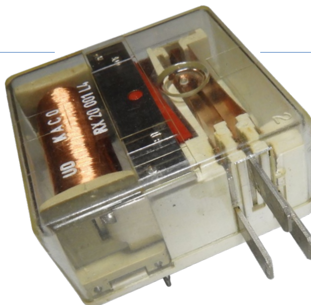
Figuur 1. Typisch vermogensrelais dat wordt gebruikt in afstandsbediende netschakelaars.
