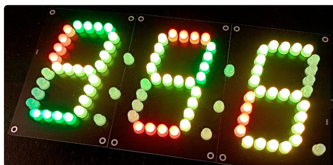
Figuur 2. Drie gecascadeerde digits met overvloeiende cijferweergave.
