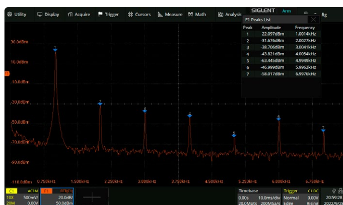
Figuur 4: FFT-spectrum van het uitgangssignaal.
