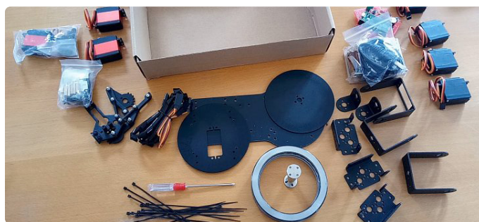
Figuur 2. De 6 DOF robotarm wordt geleverd als compleet bouwpakket.
