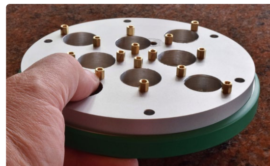
Figuur 10: De afstandhouders staan ook mooi op de massieve aluminiumplaat.
