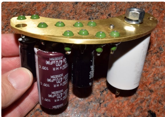
Figuur 14: De volumieuze elektrolytische condensatoren benodigen hun eigen messing plaat.
