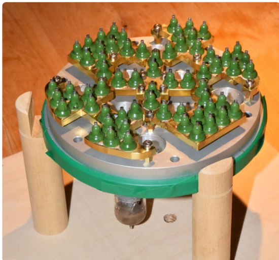
Figuur 12: Soldeerterminals met bijna vintage groene glazen isolatoren.
