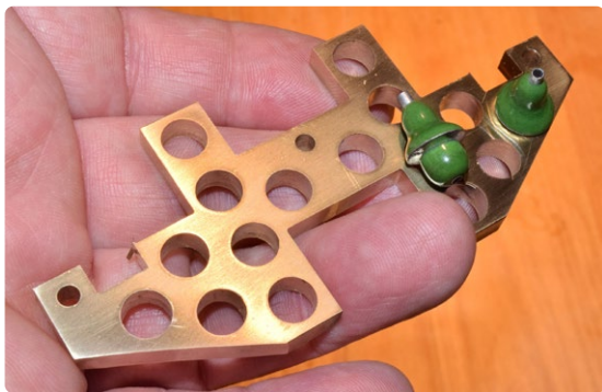
Figuur 11: Geheel passend bij de buizentechniek: een "circuit board" van massief messing.
