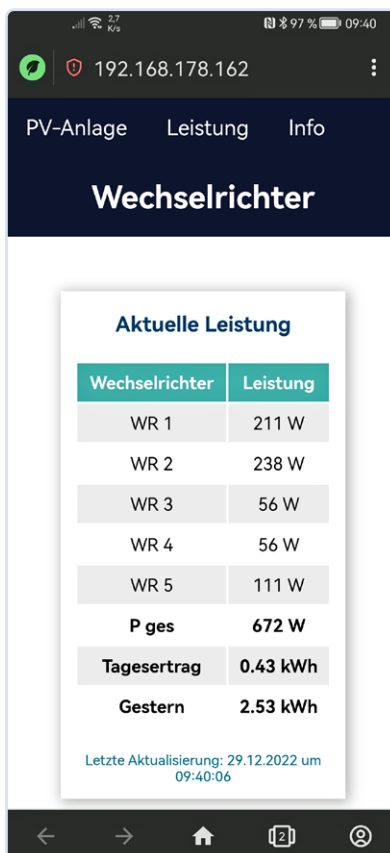
Figuur 6. De geïntegreerde webinterface geeft de meetresultaten weer.
