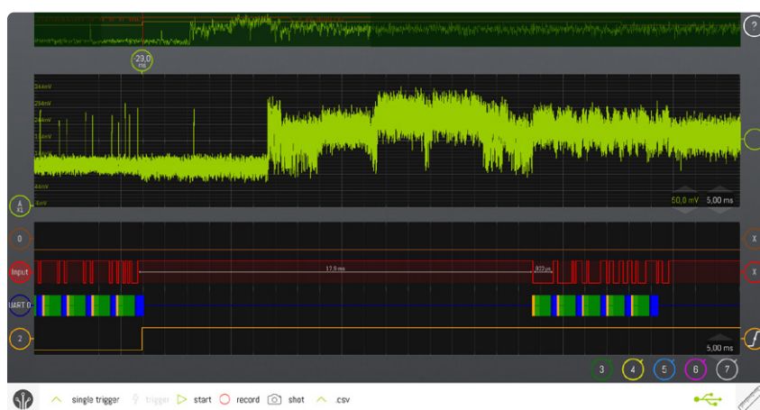
Figuur 10. Voedingsstroom (geel spoor) van een bankkaart bij controle van een onjuiste PIN-code.
