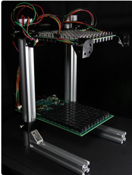
Figuur 1. Twee array's van elk 100 ultrasonie transducers worden gebruikt om een piepschuim balletje te laten zweven.
