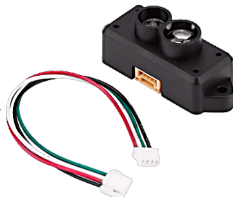
Figuur 1. De goedkope TFMMini-S LiDAR heeft een bereik van 12 m met een resolutie van 1 cm.
