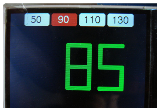
Figuur 4: In scherm 2 wordt de werkelijke snelheid weergegeven via een gesimuleerd 7-segment display.
