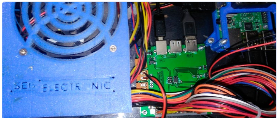
Figuur 4: ATX-voeding aangesloten op de printplaat.
