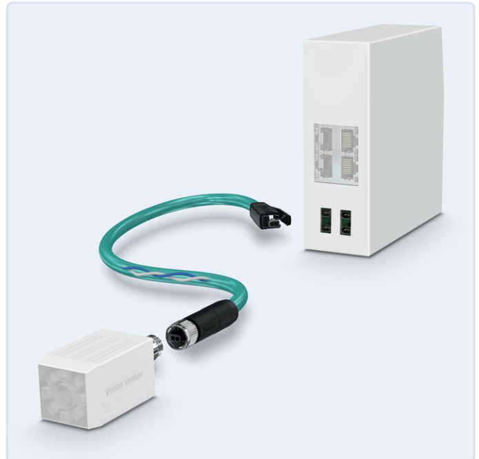
Figuur 3. Van sensor naar cloud: Single Pair Ethernet is de bouwsteen om Ethernet tot op veldniveau beschikbaar te maken.
