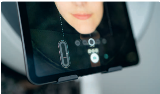
Figuur 4. De interactieve positioneringshulp voor het precies plaatsen en stilhouden van het hoofd in de Observ 520x.
