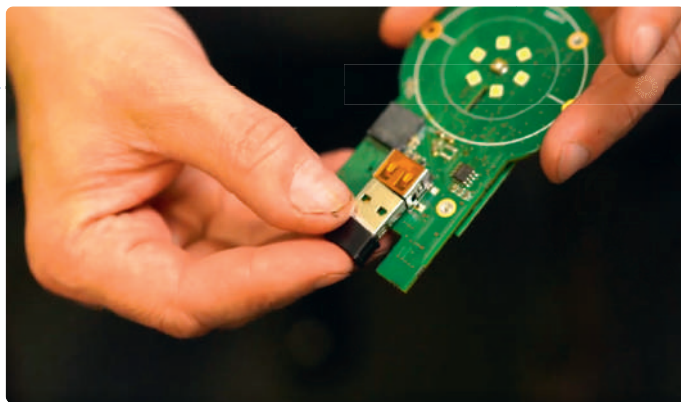
Figuur 5. Het gebruik van kant en klare, gecertificeerde modules en "dongles" vergemakkelijkt het ontwerpwerk van een complex apparaat als de Observ 520x huidanalyser.
