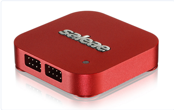
Figuur 3. Het instapmodel Logic 8 van Saleae heeft acht kanalen voor het vastleggen van mixed signalen in een piepkleine, machinaal bewerkte aluminium behuizing van slechts 5,3 cm breed (bron: Saleae).
