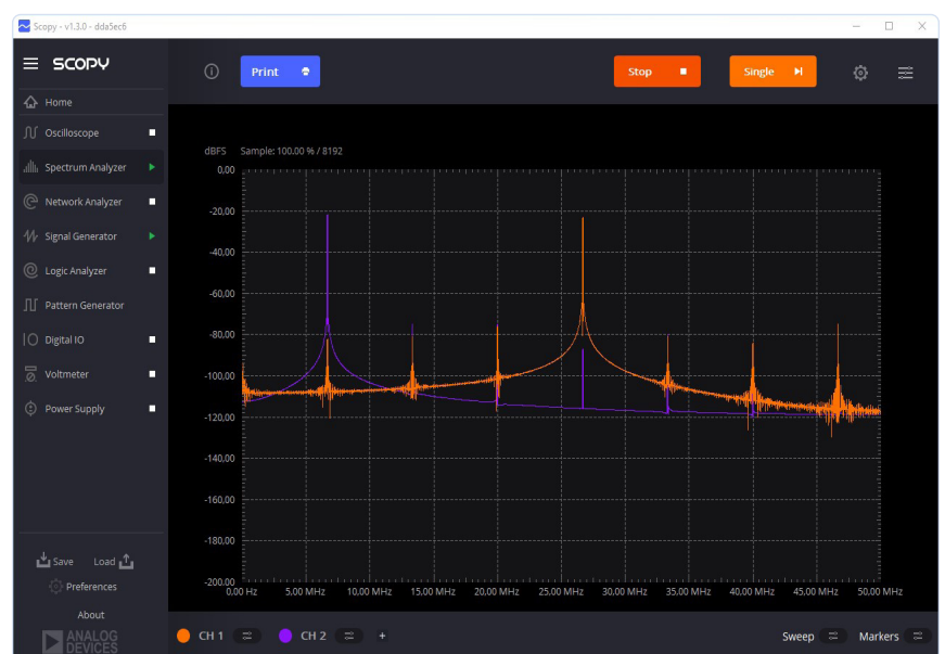
Figuur 7. De GUI is van cruciaal belang voor het succes van elk 'headless' meetinstrument. Scopy biedt heldere toegang tot de functies en instellingen onder alle besturingssystemen en op Android-tablets.
