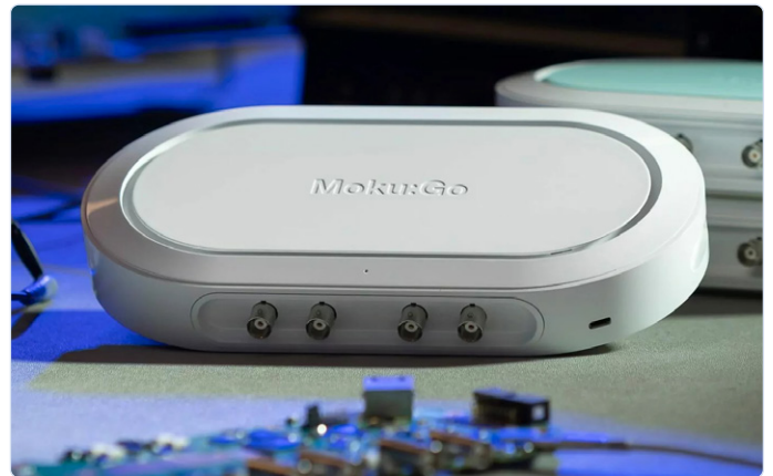
Figuur 2. De Moku:Go is het instapmodel van de draagbaar test- en meetinstrumenten van Liquid Instruments (bron: Liquid Instruments).
