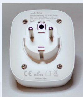
Figuur 9. De behuizing van de EU6S is met vier schroeven dichtgeschroefd.
