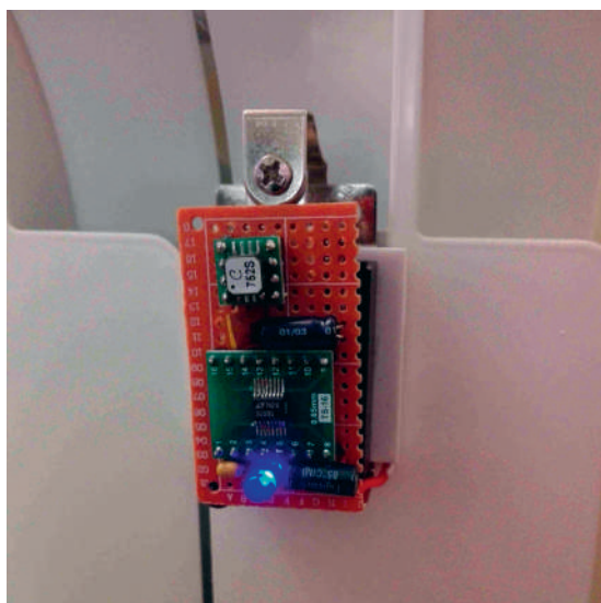
Figuur 2. De schakeling is op de voorzijde van een radiator gemonteerd en komt in werking wanneer de temperatuur gaat toenemen.
