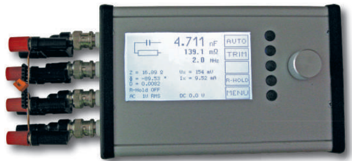
Figuur 3. De 2 MHz LCR-meter met zelfgemaakte meetklem en een condensator van 4,7 nF/1%.
