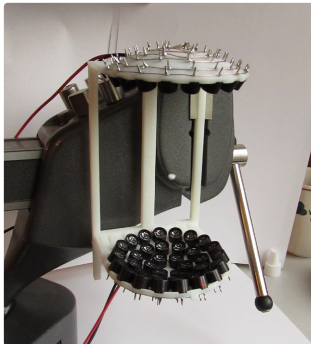
Figuur 4. Een piepklein piepschuim-balletje zwevend in de TinyLev.
