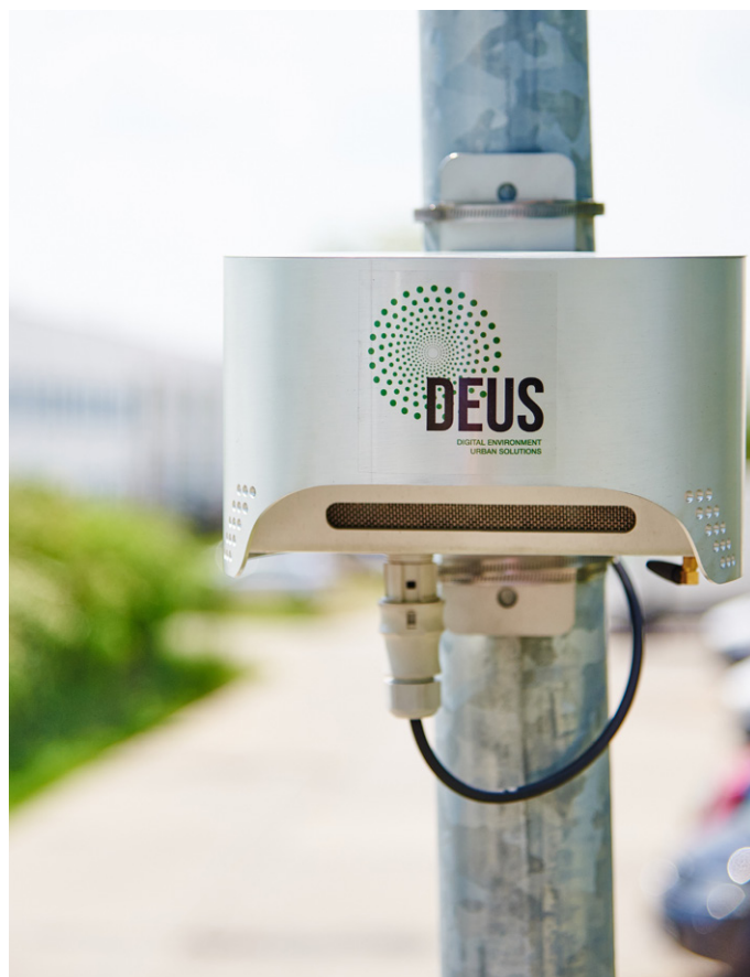
Figuur 5. DEUS POLLUTRACK fijnstof-sensoren verzamelen gegevens van stationaire en mobiele IoT-eenheden. De gegevens worden aan het backend geleverd met behulp van 4G en 5G cellulaire netwerken (bron: DEUS POLLUTRACK).
