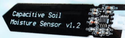
Figuur 3. Voorbeeld van een laagfrequente capacitieve sensor (bron: [3]).
