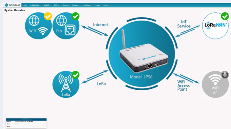
Figuur 5. Communicatiewegen die via de LPS8-gateway beschikbaar zijn.
