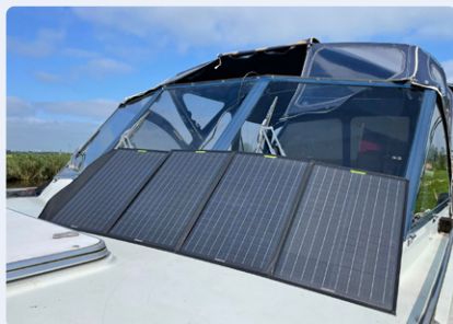
Figuur 9. Het door Martin en Detlev gekozen opvouwbare zonnepaneel kan onderweg benedendeks worden opgeborgen. Het heeft een vermogen van 120 Wp (bron: Martin Jepkens).
