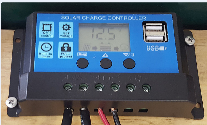
Figuur 5. Dit soort laadregelaars heeft zeker geen MPPT-functionaliteit (zelfs als er een sticker met die letters op zit!) (bron: Department of Energy van de Verenigde Staten).
