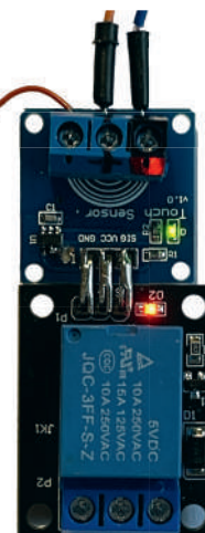
Figuur 1. Het blauwe sensorboard en het relaisboard zijn aangesloten.
