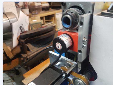
Figuur 5. De pulsgever voor de synchronisatie is met behulp van een adapter gemonteerd...
