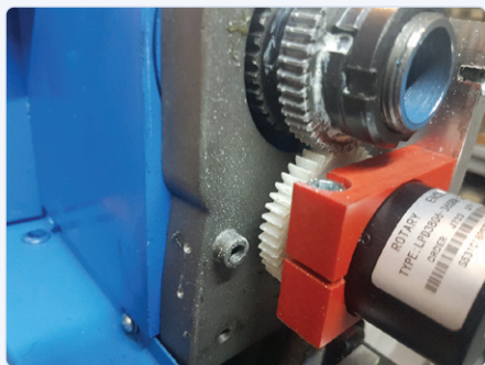
Figuur 6. ...en wordt via een tandwiel uit de gesloopte overbrenging aangedreven.
