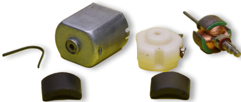
Figuur 1. De onderdelen van een FHP DC-motor. De commutator is duidelijk te zien op de rotoras naast de ankerspoelen (bron: Shutterstock/Pixel Enforcer).
