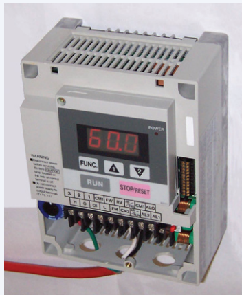
Figuur 8. Een kleine frequentieregelaar voor inductiemotoren met een nominaal vermogen van een paar kW. Met deze elektronische schakeling kan het toerental worden ingesteld. Er zijn ook grotere versies beschikbaar, die meer geavanceerde functies bieden (foto: C.J. Cowie, CC 3.0 [6]).
