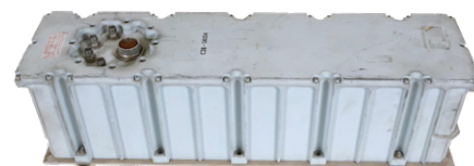
Figuur 2. Collins Radio S-Band-versterker met lopende-golfbuis gebruikt voor de communicatie met de aarde tijdens de Apollo-missie. (Bron: Ken Shirriff)
