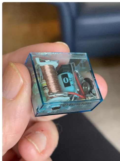
Figuur 2. Een gewone instelpotmeter plus een seriële weerstand passen ook in de behuizing.
