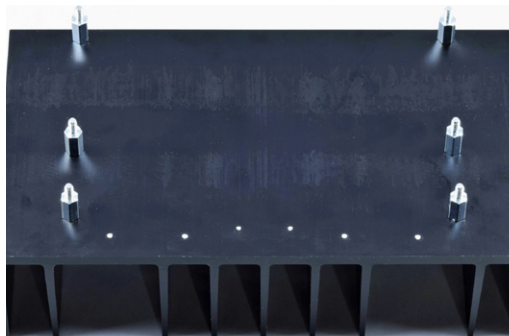
Figuur 12. De boorgaten voor de bevestiging van de eindtransistoren zijn gemarkeerd.
