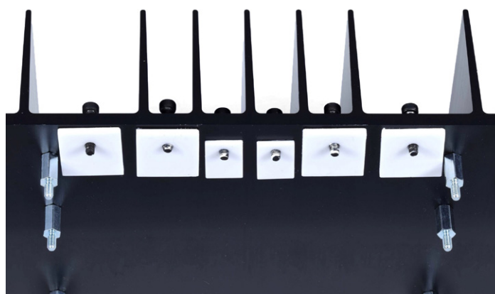
Figuur 21. De keramische isolatiepads worden aan één zijde bestreken met een dun laagje warmtegeleidende pasta en over de half ingestoken schroeven geschoven. Het koellichaam moet hiervoor rechtop staan.
